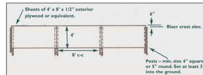
**5 SEDIMENT TRAP BAFFLE**
