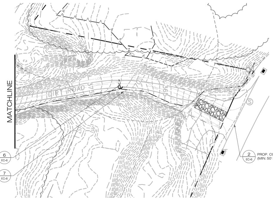
**1 SEDIMENTATION & EROSION CONTROL PLAN**
